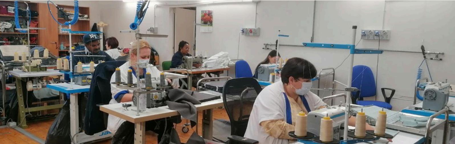
Oggi la sartoria occupa due aree: una demandata alla **lavorazione** ed una alla **rifinitura** e al **controllo qualità** del prodotto, entrambe dotate di impianto ad aria compressa.
